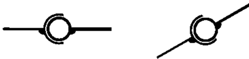
Figure.13. Schématisation normalisée de la liaison rotule (schémas plan et spatial identiques).
